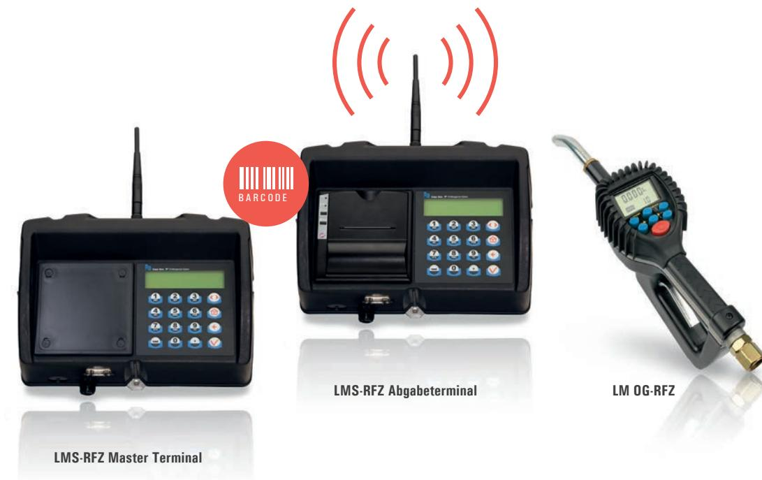
Das LMS-RFZ Ölmanagement System bietet eine kabellose Kommunikation zwischen Abgabeterminals und Zähler auf Basis der ZigBee® Funktechnologie. Hierbei bilden alle Terminals ein dynamisches Funknetzwerk, welches die Funkabdeckung in Werkstätten optimiert und auch größere Distanzen überbrücken kann. Des Weiteren können problemlos mobile Faßwagen eingebunden werden. Das System kann über eine frei programmierbare HOST Schnittstelle an ein Warenwirtschaftssystem angebunden werden.
